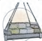
吊運作業，物料須細綁牢固
