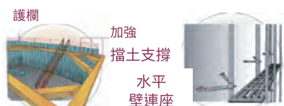
加強擋土支撐並設置護欄
