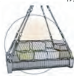
吊運作業，物料須綑綁牢固
